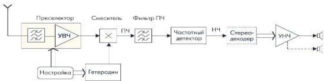
Рисунок 1.2 - Обобщенная блок-схема супергетеродинного ЧМ - приемника
